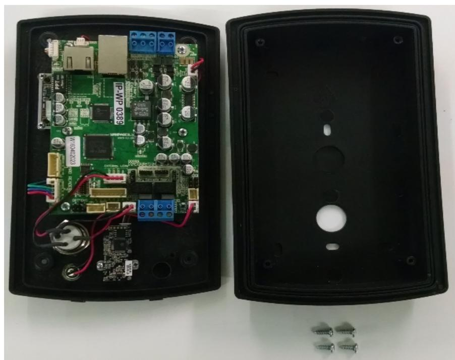
*Figura 3 – Tapa plástica delantera y trasera IP Access*
