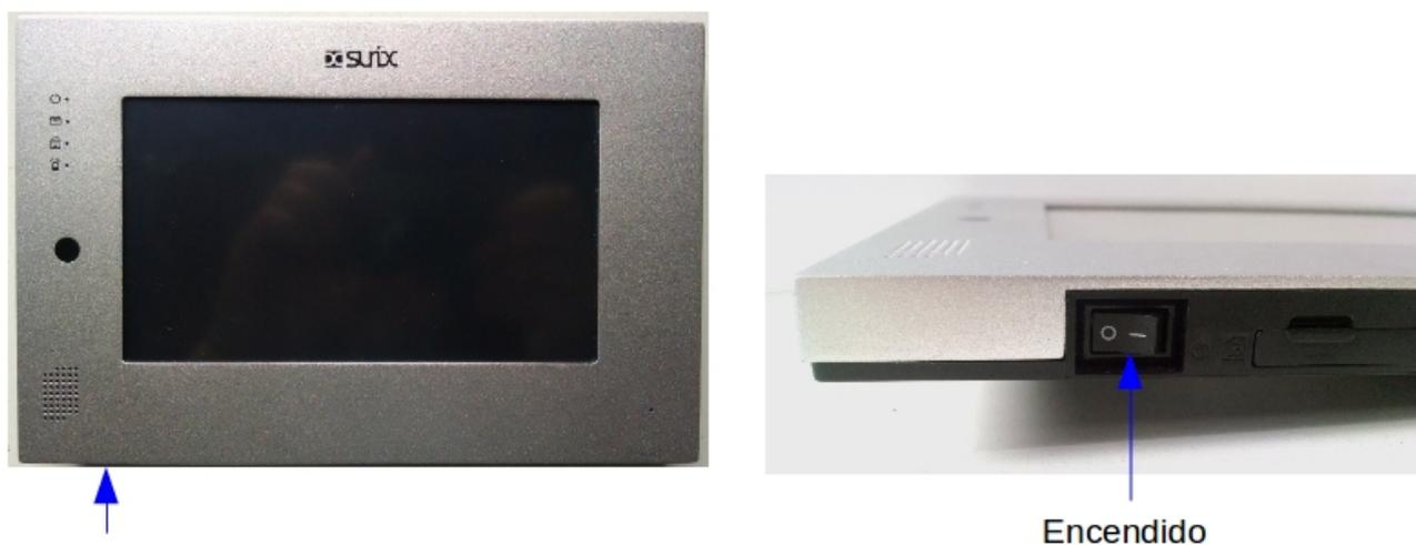
*Figura 2 – Encendido de la pantalla IP*
